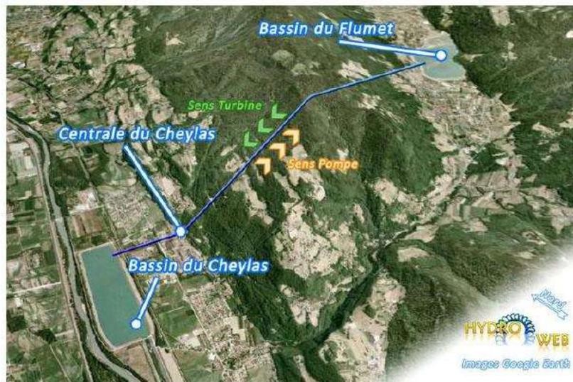
Dans le détail, le bassin fait l'objet d'un important marnage (jusqu'à 6 m de hauteur) lié au fonctionnement de la STEP et à sa sollicitation par le réseau.
